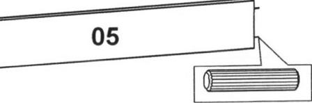
В отверстия на торцевых кромках опорной продольной стенки 05 установить шканты.
