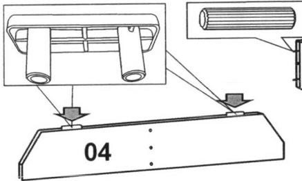
В отверстия на кромке опорных стенок 04 установить наконечники.
