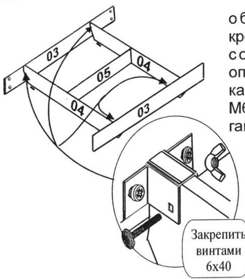
Царги 03, предварительно оборудованные цокольной кроватной стяжкой, установить на собранную конструкцию из опорных стенок 04 и 05 и закрепить, как показано на рисунке, винтами М6х40 при помощи барашковой гайки.
